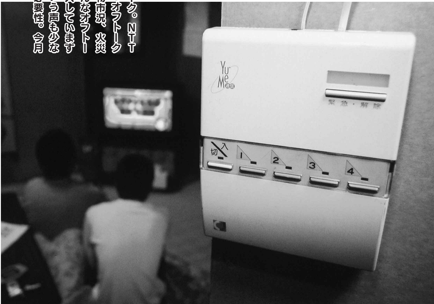
一般家庭にあるオフトークの宅内接続装置
