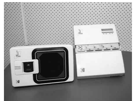
各加入世帯にある宅内接続装置
